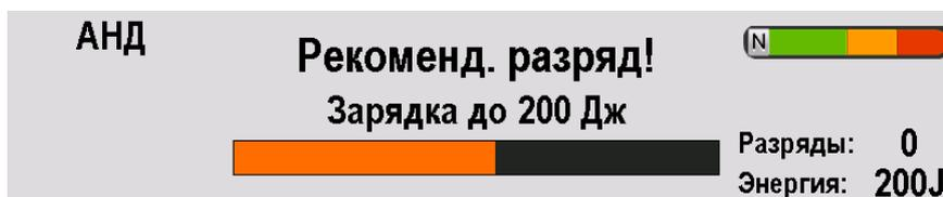
Во время зарядки оборудования продолжается анализ сердечного ритма. Если до подачи разряда обнаруживается изменение ритма, при котором разряд теряет смысл, накопленная энергия сбрасывается устройством.
