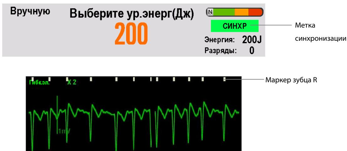
Мониторинг ЭКГ осуществляется посредством многофункциональных гибких электродов, внешних плоских электродов или набора отведений ЭКГ. Разряд подается через гибкие или плоские электроды. В случае синхронизированной кардиоверсии рекомендуется получать ЭКГ пациента с помощью набора отведений ЭКГ.
