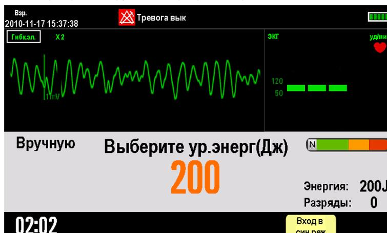
В расширенной области ЭКГ отображаются кривая ЭКГ и соответствующие параметры. В середине экрана отображаются режим дефибрилляции, значок синхронности, подсказки, выбранный уровень энергии, индикатор сопротивления контакта и счетчик разрядов.
