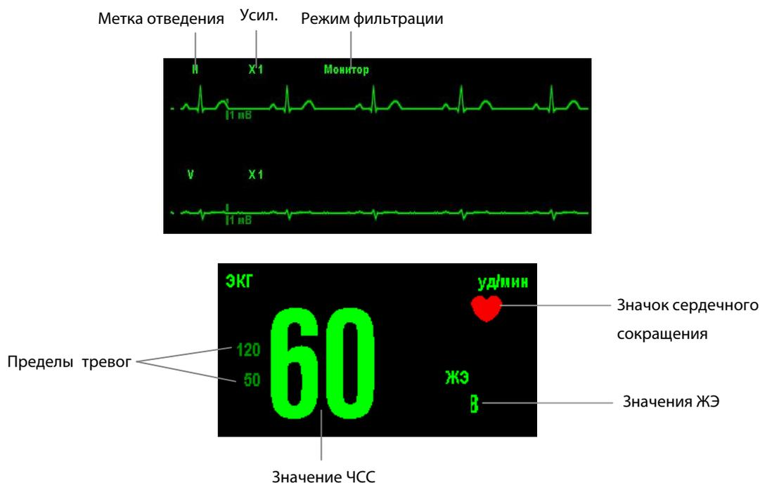
Значения ЖЭ отображаются только в том случае, когда включен анализ аритмии. В случае мониторинга ЭКГ с помощью гибких или плоских электродов вместо значения ЖЭ отображаются прочерки «---».
