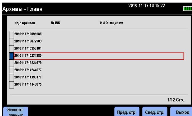
Режим архива доступен только в режимах монитора, ручного дефибриллятора и кардиостимулятора. Когда открывается главный экран архивов, мониторинг пациента и терапия автоматически завершаются, и последний добавленный пациент сохраняется как последний архивированный пациент.
