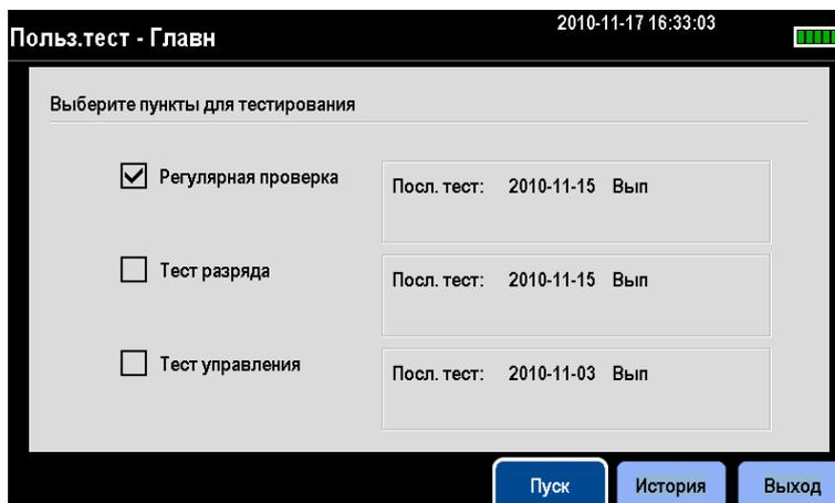
Выберите проверки, которые требуется выполнить, и нажмите [Пуск], чтобы начать пользовательскую проверку. По завершении выбранных проверок появится сообщение «Тест выполнен». После этого можно нажать функциональную клавишу [Запись], чтобы распечатать результаты проверки.
