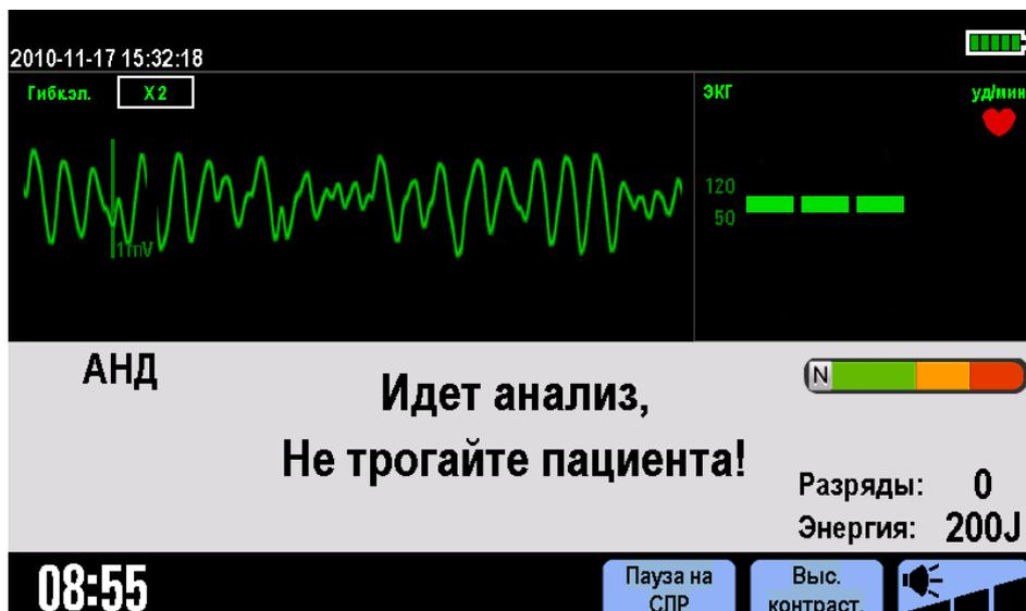
В режиме АНД отображаются числовые значения ЧСС и одна кривая ЭКГ, полученные с помощью многофункциональных гибких электродов. Под кривой ЭКГ находится информационная область, в которой отображаются режим дефибрилляции, подсказки, индикатор сопротивления контакта, выбранная энергия и счетчик разрядов.
