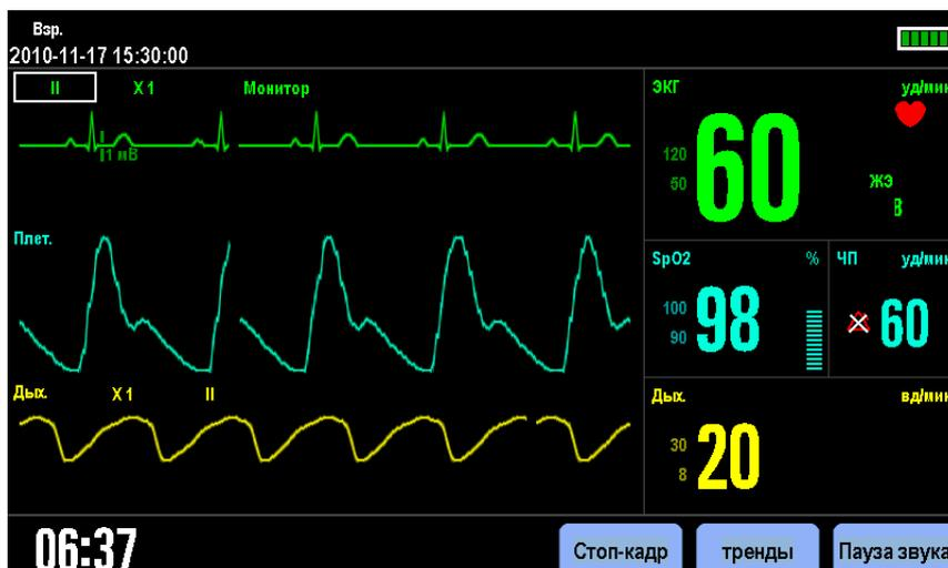
Режим монитора включается переключением ручки выбора режима в положение «Монитор». При работе в режиме монитора оборудование отображает до двух кривых ЭКГ, показания частоты сердечных сокращений, значения других доступных параметров и действующие настройки сигналов тревоги.
